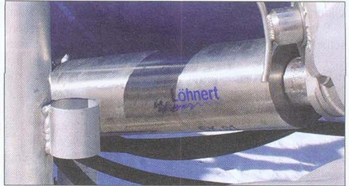
*Der Schneekatalysator wird einfach - auch nachträglich - zwischen der Wasserversorgung und dem Schnee-Erzeuger eingebunden*
