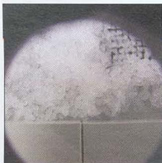
Entscheidend für die Schneequalität ist auch der Anteil des nicht-kristallisierten Wassers im Schneekorn (das in der Folge zu Eis werden kann): Während bei unbehandeltem Schnee der Wassergehalt zwischen 2,0 und 0,0 % liegt, erreicht der Katalysator-Schnee praktisch ausnahmslos 0,0 %.
